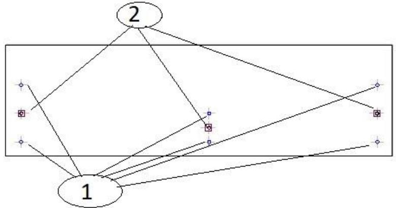
2.7. В передний бок 5 вставляем шканты и вбиваем футорку согласно схеме (отверстие 1 для шкантов, отверстие 2 для футорки).
