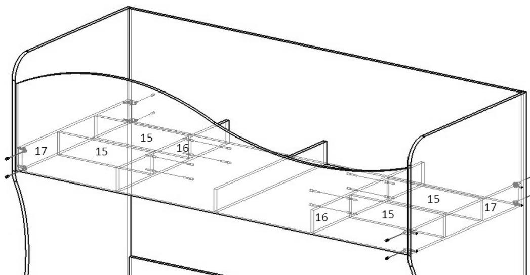
10. Вставляем в трубки распорные втулки и евроинтами крепим к бокам лестницы 10. Соединяем бока лестницы 10 распорками 9 при помощи евроинтов.
